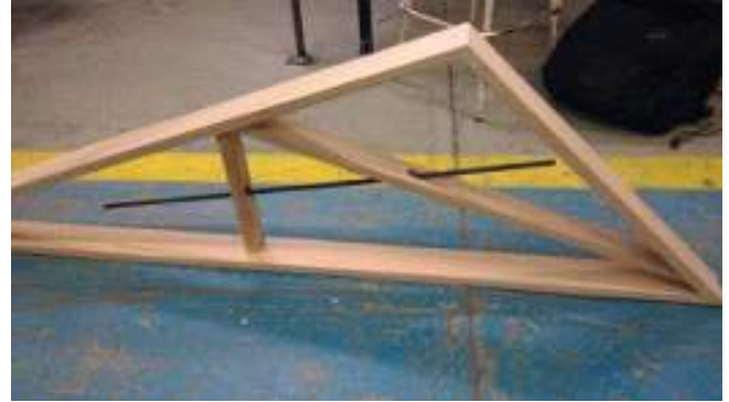
Figura 14. Estructura interna con varilla de acero
