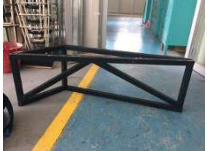
Figura 22. Estructura de la base ya soldada
