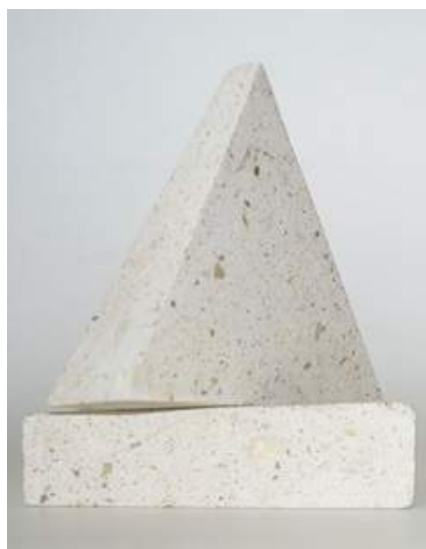
Figura 13. Prototipo triangular realizado con merma de loseta de cantera gris Fuente: elaboración propia
