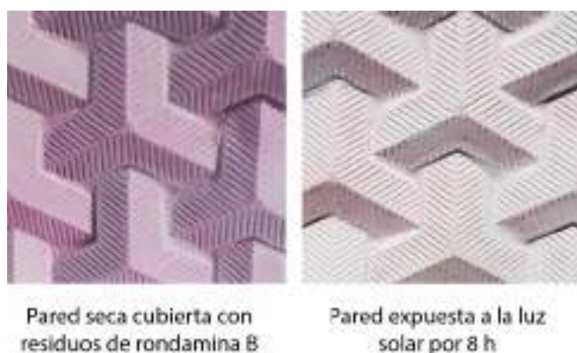
Figura 14. Registro de actividad purificante sobre la pared de módulos
