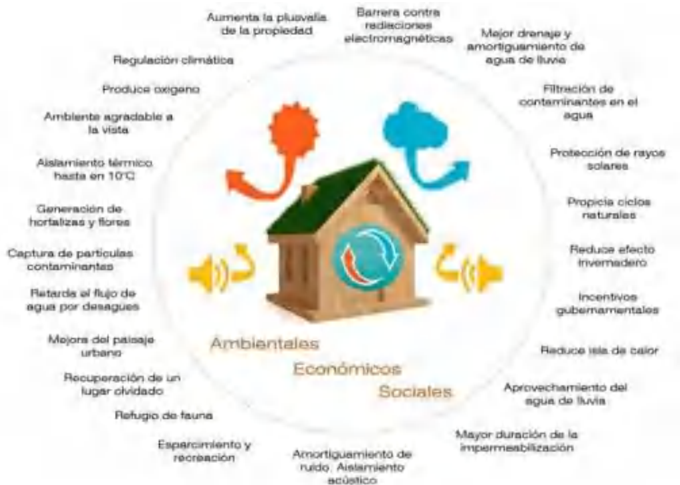
Figura 8. Ventajas de contar con un techo verde. Fuente: elaboración propia.
