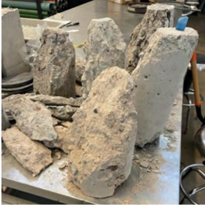
Los residuos de cilindros fueron sometidos a un proceso de trituración primaria utilizando una trituradora de materiales pétreos.
