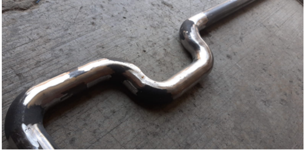
FIGURA 4. Disección de una reparación. Detalle de soldadura de estructura base.
