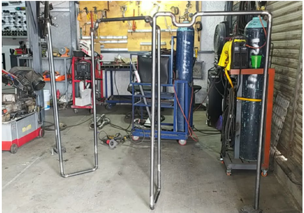
FIGURA 5. Disección de una reparación. Estructura base armada.
