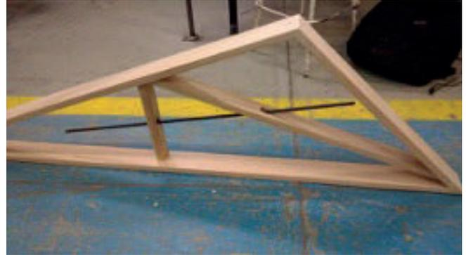
Figura 14. Estructura interna con varilla de acero
