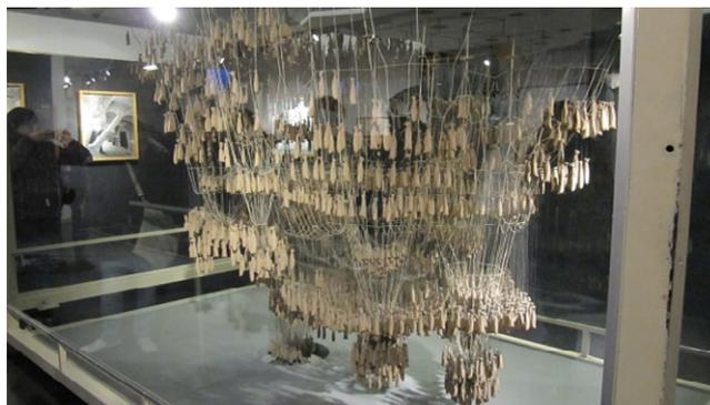
Figura 2. Modelo de cadena colgante para el proyecto Colonia Güell. Fuente: Adaptado de "Modelo de cadena colgante para Colonia Güell" por wallygrom, 2010. CC BY-SA 2.0
