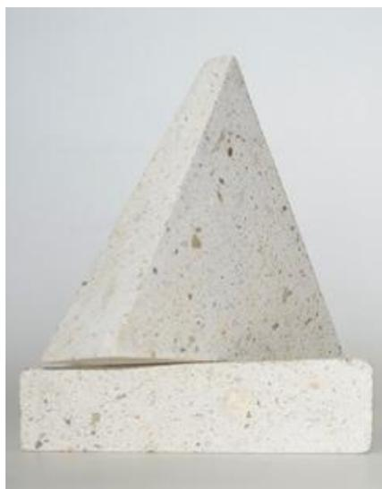
**Figura 13.** Prototipo triangular realizado con merma de loseta de cantera gris
