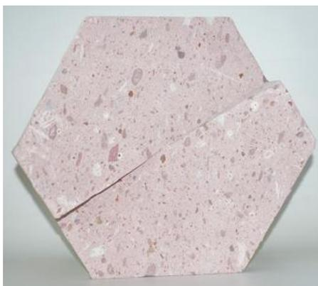
**Figura 12.** Prototipo hexagonal 1 realizado con remanentes de centro de columna de cantera rosa
