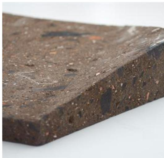
**Figura 14.** Detalle de prototipo hexagonal 2 realizado con sobrante de loseta de cantera café
