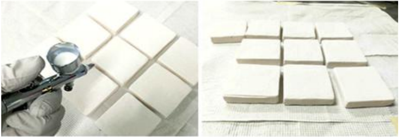
Figura 5. Aplicación de dióxido de titanio sobre las piezas muestra
