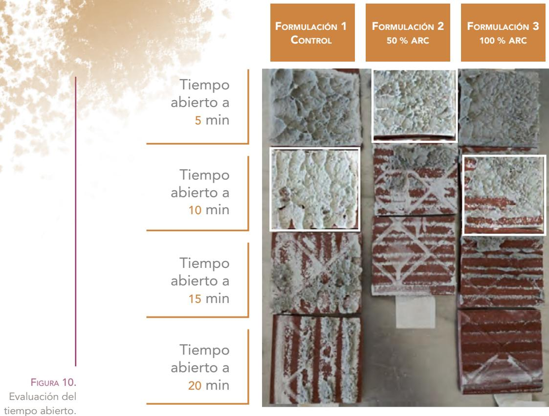
Las formulaciones 1 (control) y 3 (100% ARC) cumplieron con la especificación de tiempo abierto mínimo de 10 minutos para adhesivos Tipo A requerida por la **NMX-C-420-1-ONNCCE (2017)**. La formulación 2 (50 % ARC) está fuera de especificación, ya que únicamente logró un tiempo de 5 minutos. Destaca que ninguna de las tres formulaciones evaluadas alcanzó un tiempo abierto mayor a 10 minutos.
