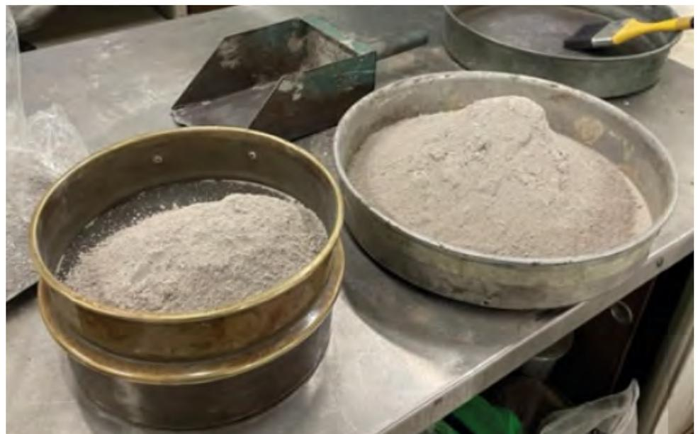
FIGURA 4. Control granulométrico de agregados reciclados de concreto.
