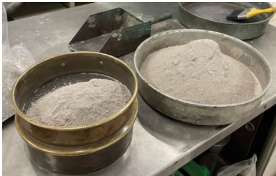
FIGURA 4. Control granulométrico de agregados reciclados de concreto.
