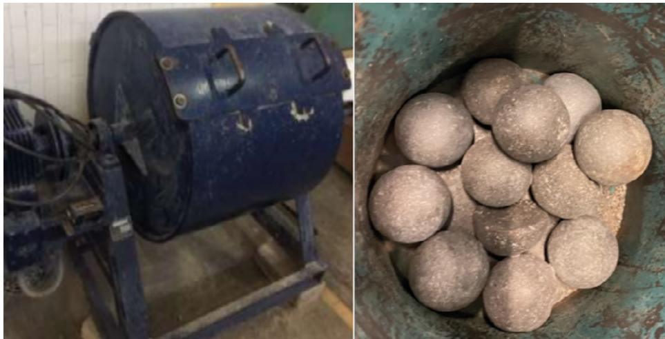
FIGURA 3. Izquierda: equipo de abrasión Los Ángeles FI-UAQ. Derecha: esferas de molienda.
