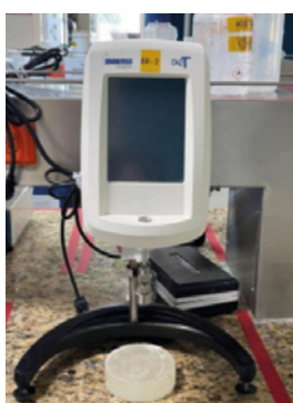
FIGURA 6. Equipo Brookfield utilizado para lecturas de viscosidad de adhesivos cerámicos.
