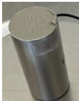
FIGURA 5. Medición de la densidad en mezclas de adhe- sivos cerámicos.
