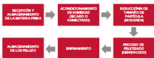
Figura 2. Etapas de la producción de pellets combustibles
