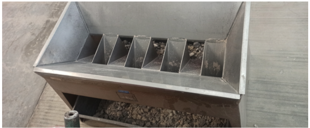
FIGURA 4. Cuarteador con material pétreo. Se observan las ranuras que dividen por la mitad cada muestra y las depositan en la bandeja inferior. Fuente: elaboración propia.
