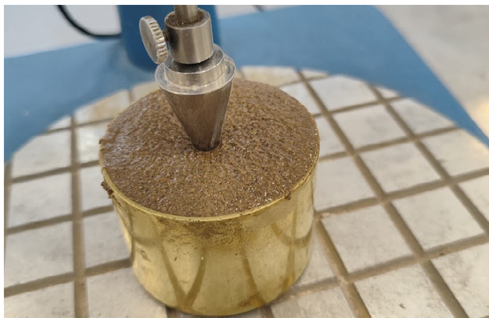
FIGURA 5. Cono de penetración colocado sobre la muestra de material para determinar el límite de consistencia. Fuente: elaboración propia.
