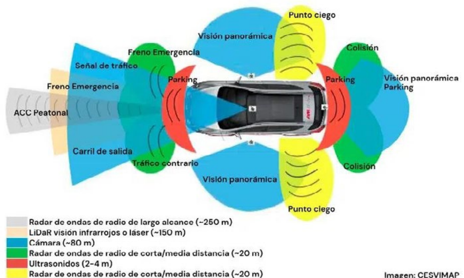
Figura 2. Elementos de un vehículo para los ADAS [6].
