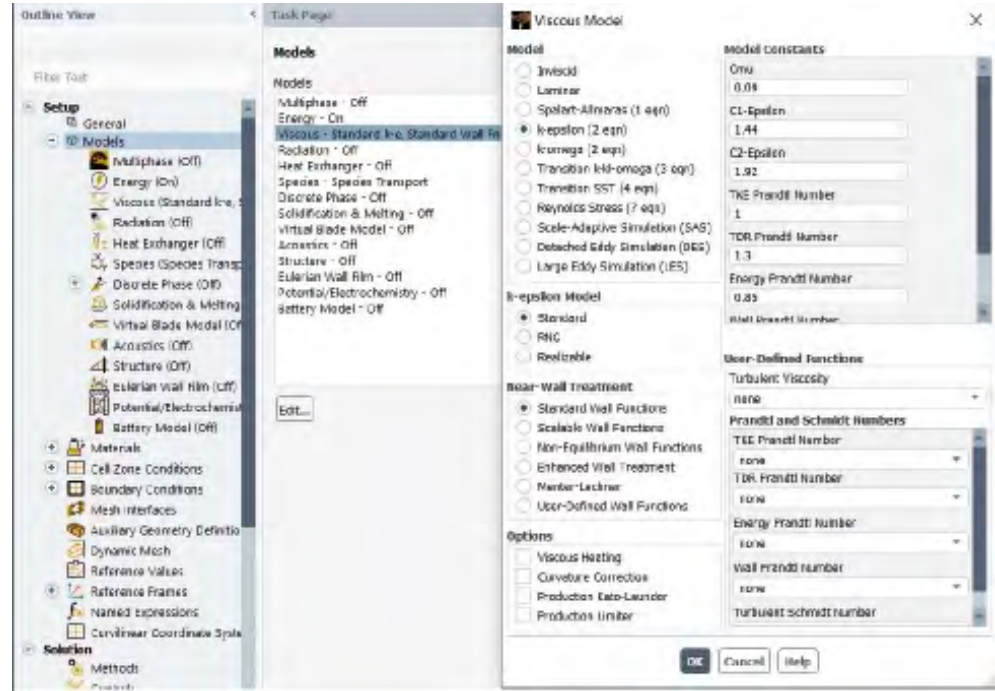
FIGURA 6. Interfaz de selección de modelos de turbulencia en la biblioteca de modelos de ANSYS® Fluentm 2023 R2.
