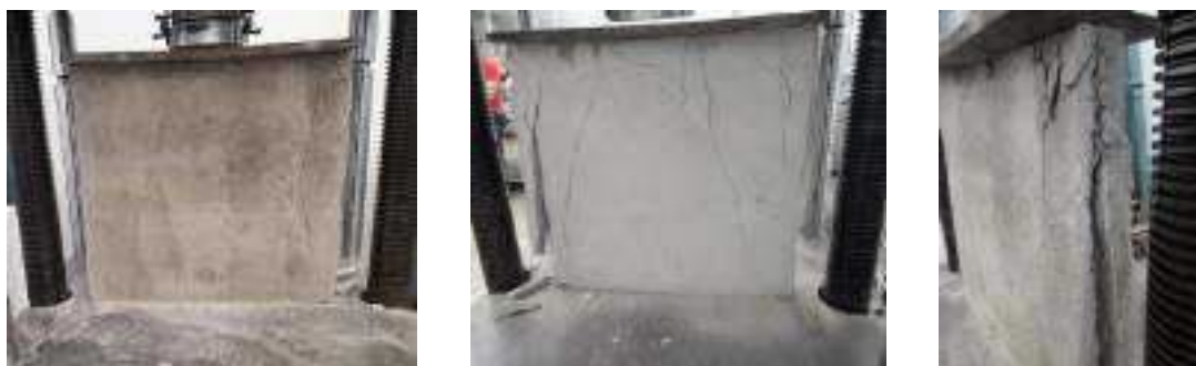
Figura 9. Grietas y modos de falla presentados en paneles de ferrocemento.
