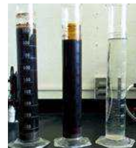
Figura 4. a) Cribado del material seco a través de los tamices; b) Preparación del material defloculante para el análisis hidrométrico; c) Probetas analizadas a través del método del hidrómetro de Bouyoucos.
