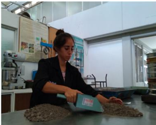
Figura 3. Cuarteo de material RAP en Condición Original. Fuente: Elaboración propia
