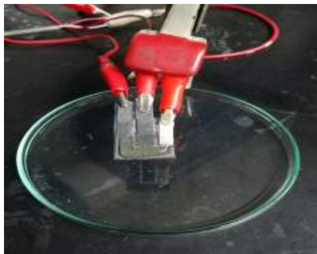
Figura 6. Prototipo de dispositivo de biosensor de glucosa (FcMe2-LPEI/GOx) conectado al potencióstato para su análisis. El área de trabajo de los electrodos se encuentra sumergida en PBS pH 5.7.
