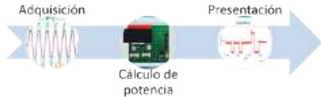
Figura 1. Proceso general del sistema de monitoreo
