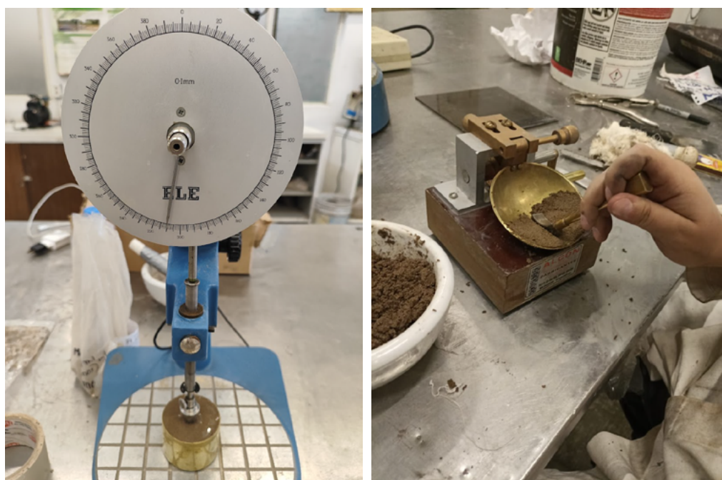
FIGURA 3. Equipo de límites de consistencia. Cono de penetración normalizado con su respectivo penetrómetro (izquierda) y copa de Casagrande (derecha). Fuente: elaboración propia.
