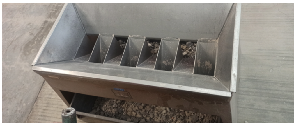
FIGURA 4. Cuarteador con material pétreo. Se observan las ranuras que dividen por la mitad cada muestra y las depositan en la bandeja inferior. Fuente: elaboración propia.
