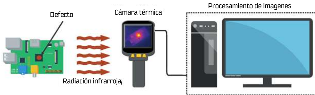
Figura 2. TI pasiva para el monitoreo de condición de un dispositivo que funciona con corriente eléctrica (Elaboración propia). Imagen térmica por OzAdrian (OzAdrian, 2012).
