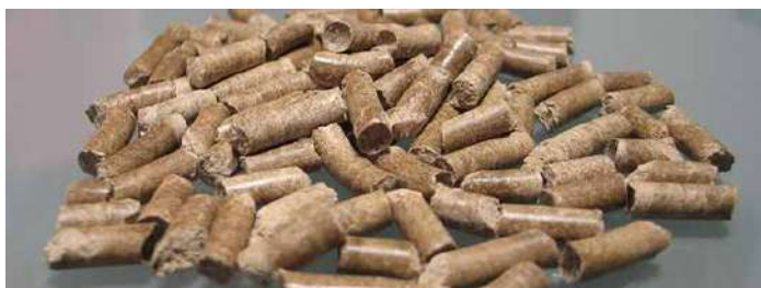
Figura 1. Pellets elaborados a partir de cascarilla de arroz
