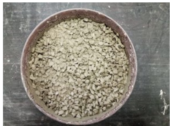
Fig. 9 Mezcla de concreto en estado fresco (A/C=0.5)
