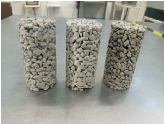
Fig. 10 Cilindros de concreto, A/C= 0.3, 0.4 y 0.5 [de izquierda a derecha]
