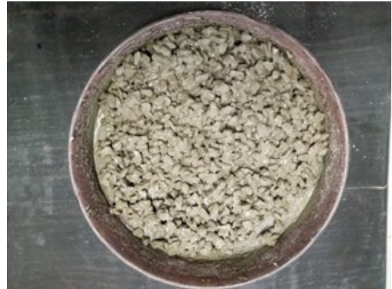
Fig. 9 Mezcla de concreto en estado fresco (A/C=0.5)
