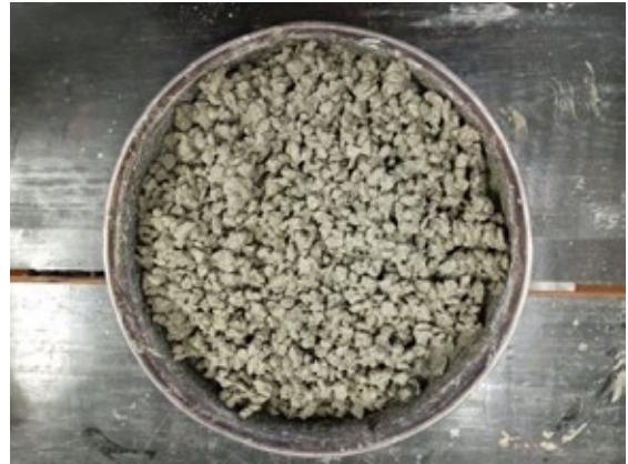
Fig. 8 Mezcla de concreto en estado fresco (A/C=0.4)
